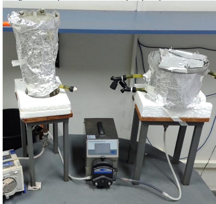
Figura 12 - Capa de alumínio usada para proteção dos reatores
