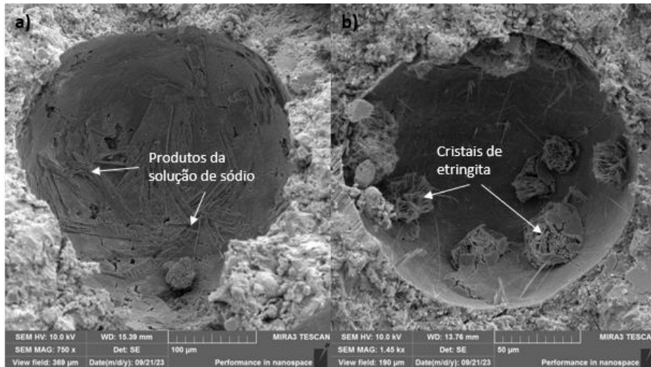
Figura 15 – Microestrutura da pasta de 0,10% de CNFa) poro da pasta com 30 dias de cura. b) poro da pasta 60 dias de cura.
