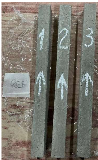
Figura 11 - Padrão de identificação das barras de argamassa
