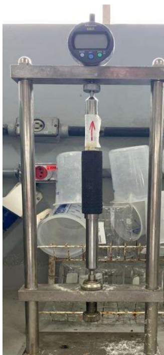
Figura 12 - Comparador e barra padrão utilizados
