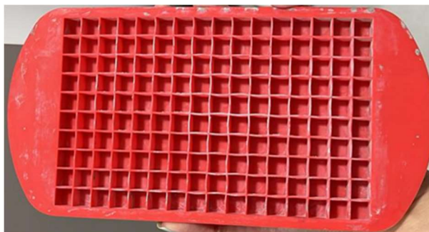
Figura 6 - Forma de silicone utilizada para a moldagem das pastas de cimento
