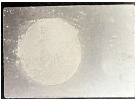
Figura 8 - Amostrador padrão utilizado para ensaio DRX
