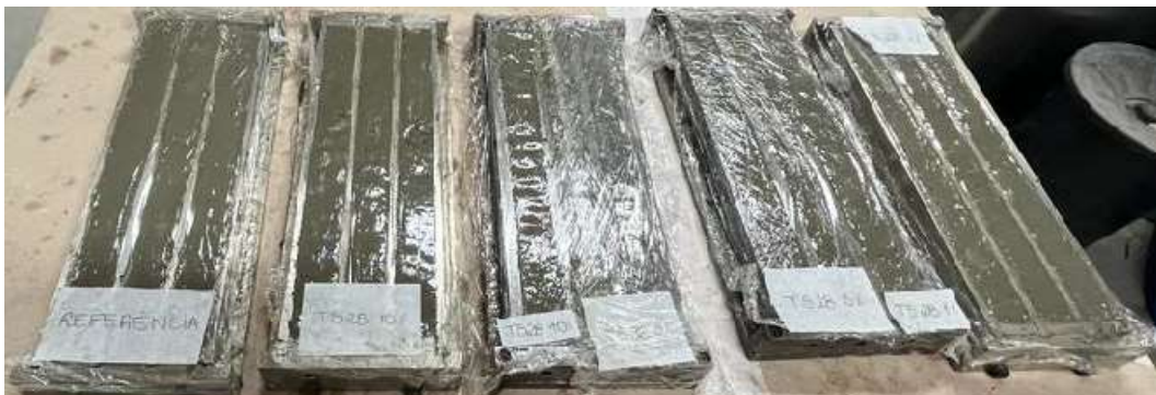
Figura 10 - Barras de argamassa imediatamente após a moldagem
