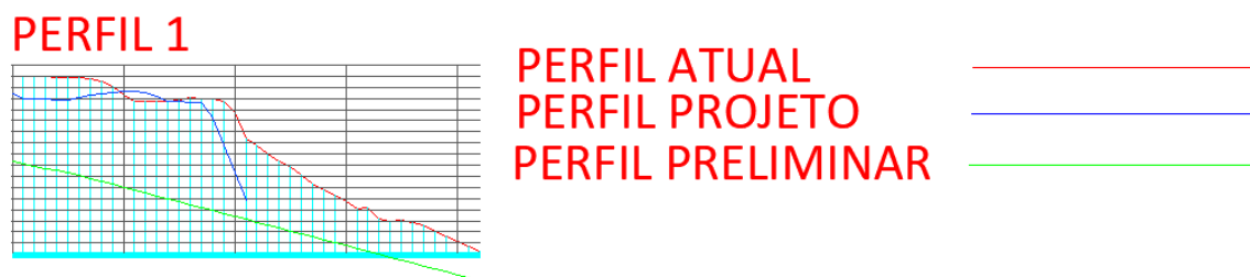
Figura 35 - Perfil do talude rompido
