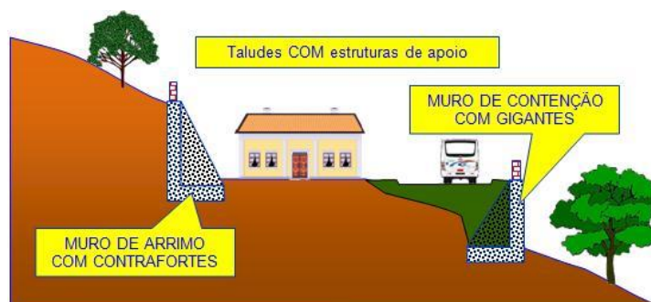
Figura 6 - Uso de contenções em taludes
