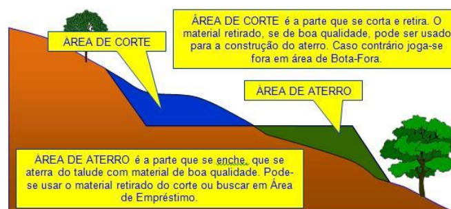
Figura 3 - Talude de corte ou aterro
