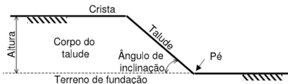
Figura 1 - Seção transversal de talude
