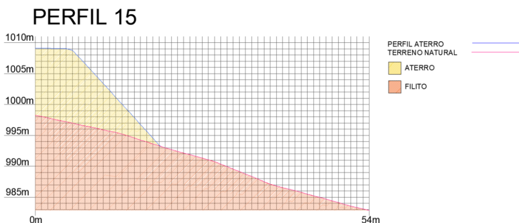
Figura 44 - Perfil 15 antes da ruptura
