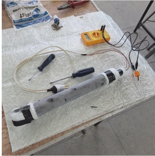
Figura 17 - Ensaio de condutividade térmica
