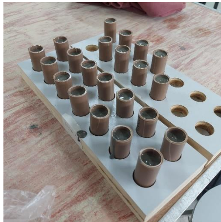
Figura 10 - Molde para corpos de prova de cimento Portland com adição de carbono
