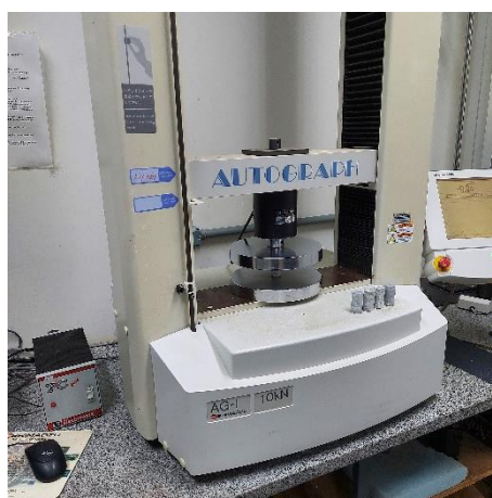
Figura 14 - Rompedor modelo AG-1 utilizado para os ensaios de compressão e tração
