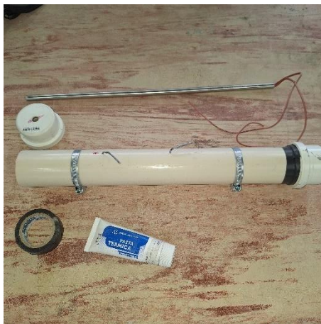
Figura 11 - Molde para confecção de corpos de prova cilíndricos para ensaio de condutividade térmica
