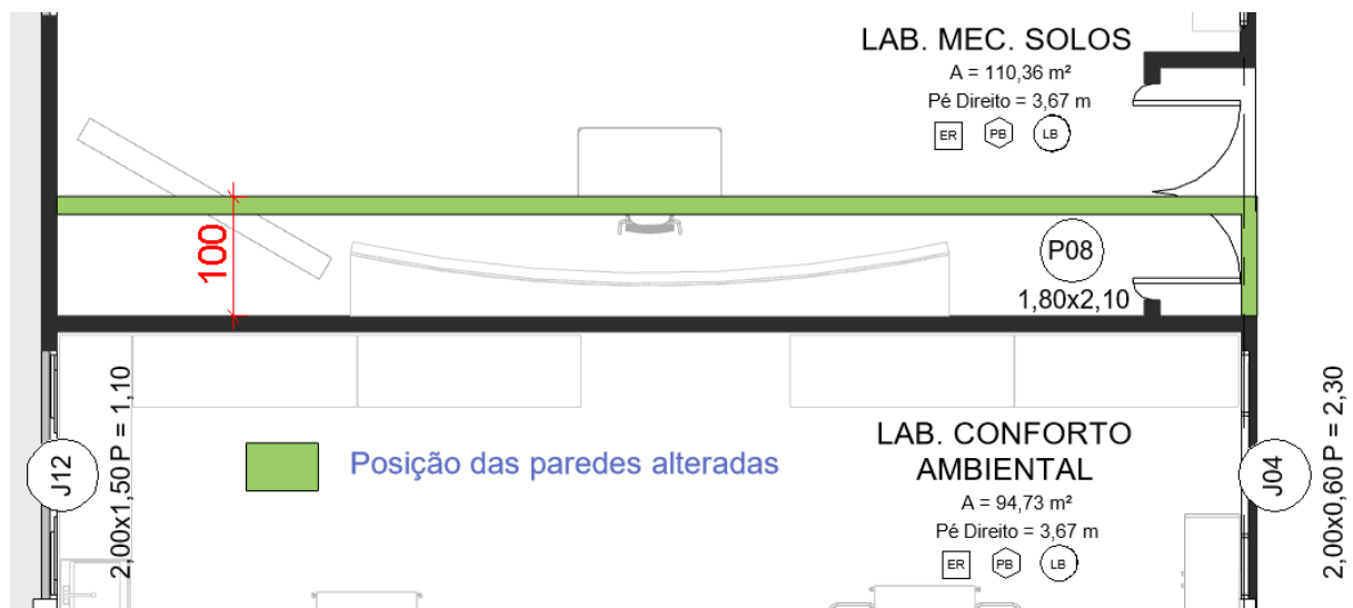
Figura 26 – Alteração da posição da parede de divisa do Laboratório de Mecânica dos Solos e do Laboratório de Conforto Ambiental – pavimento térreo
