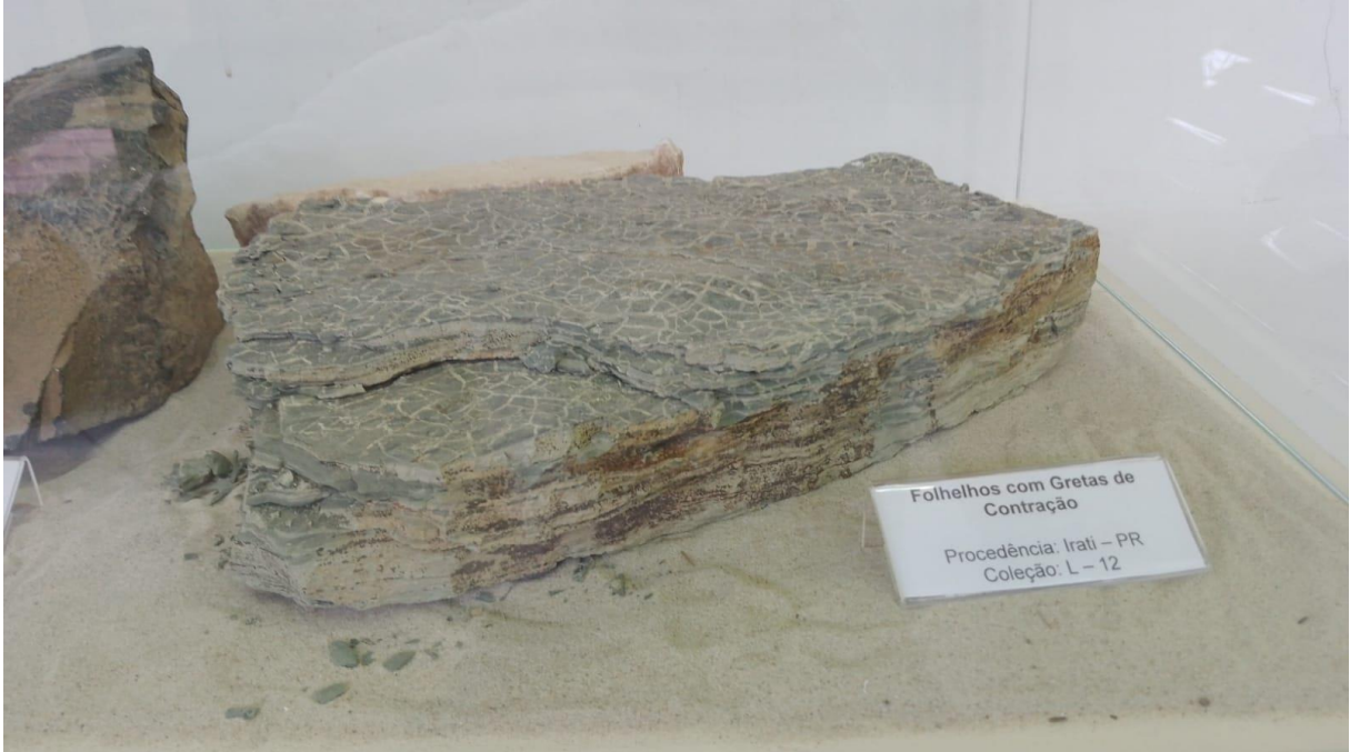
FOTOGRAFIA 7- Tensões higroscópicas em folhelho.
