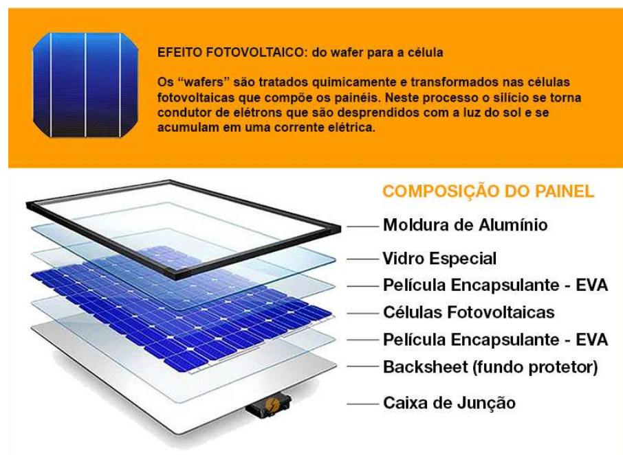
Figura 1 – Composição de um painel fotovoltaico
