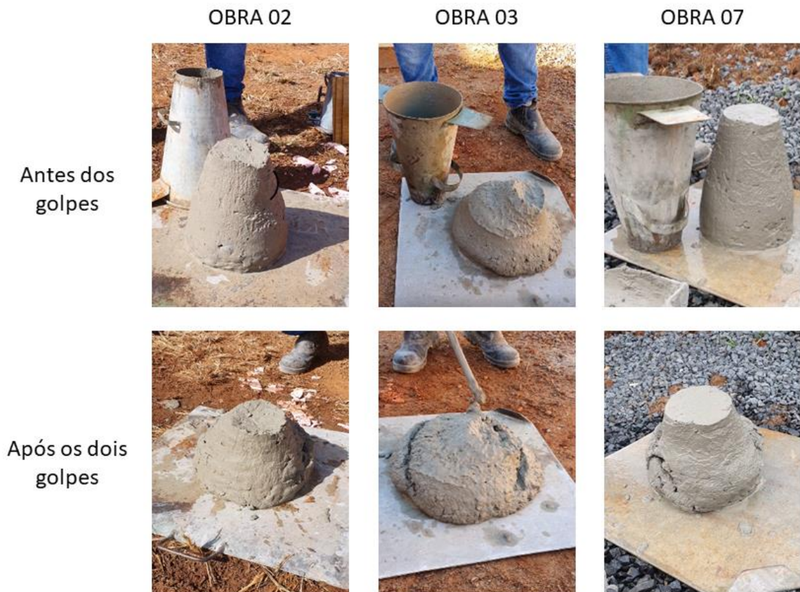
Figura 18 - Verificação da coesão do concreto após golpes com a haste de adensamento.
