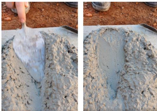
Figura 7 - Ensaio de coesão - alisamento da superfície com colher de pedreiro.
