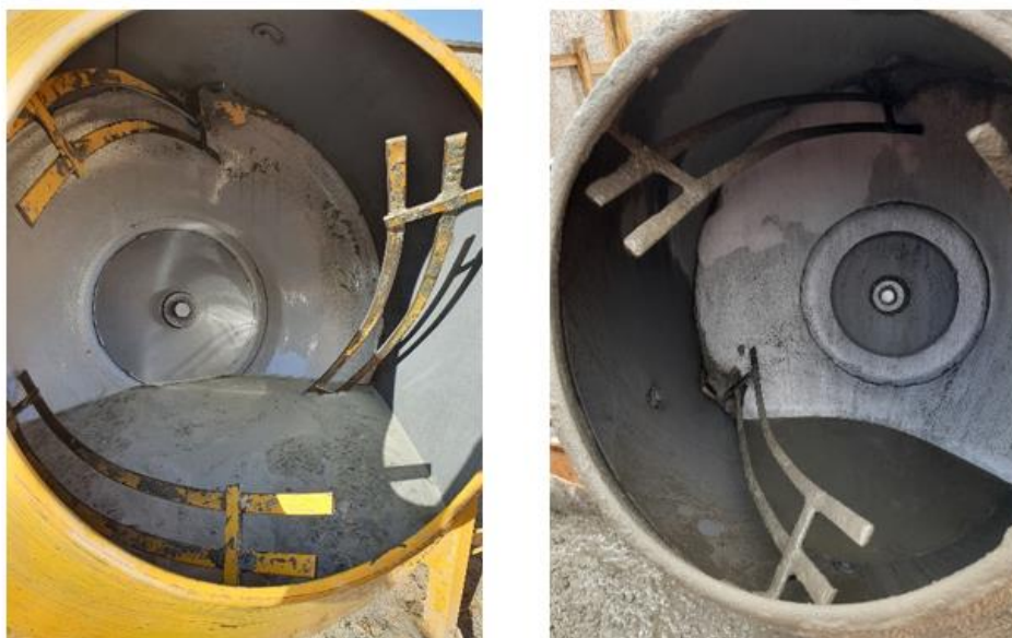
Figura 20 - Limpeza das betoneiras.
