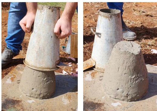
Figura 5 - Realização do ensaio da consistência pelo abatimento do tronco de cone.
