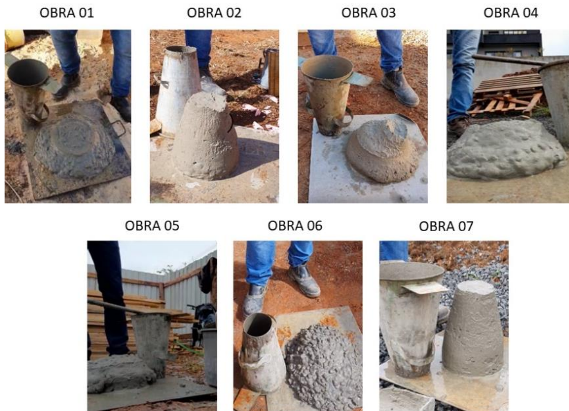
Figura 17 - Abatimento do concreto pelo tronco de cone das obras acompanhadas.
