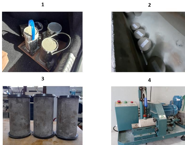
Figura 8 - Preparo dos corpos de prova para rompimento.
