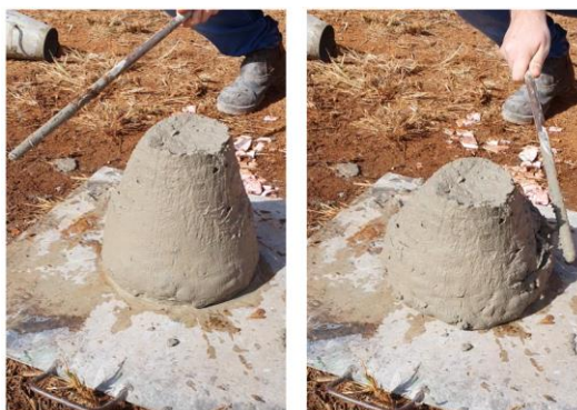
Figura 6 - Realização do ensaio da coesão.
