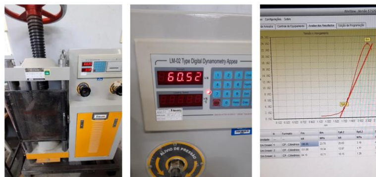
Figura 9 - Ensaio de resistência à compressão axial do concreto.
