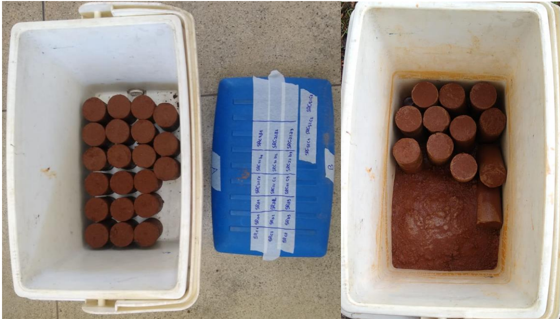
Figura 15 - Corpos de prova submetidos à saturação
