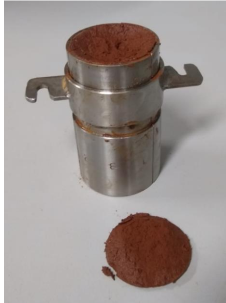
Figura 14 - Moldagem do Corpo de Prova de Sc
