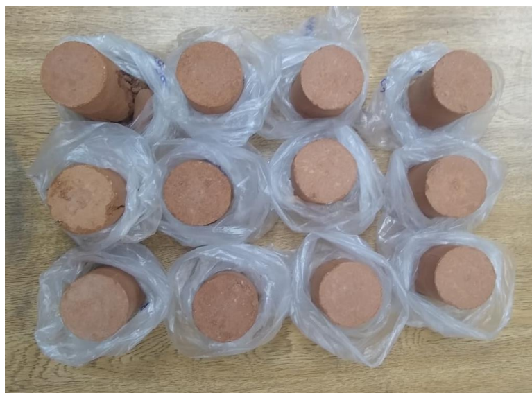
Figura 35 - Corpos de prova após ensaio de Compressão Simples – cura ambiente
