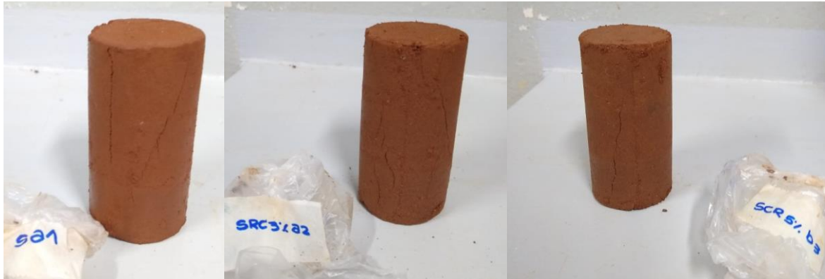
Figura 30 - Corpos de prova após ensaio de Compressão Simples
