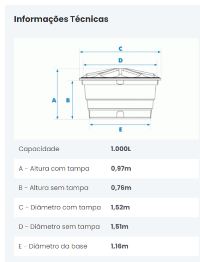
Figura 4 - Informações de Caixa de Água
