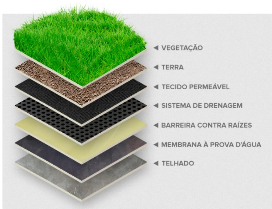
Figura 13 - Estrutura de um telhado verde
