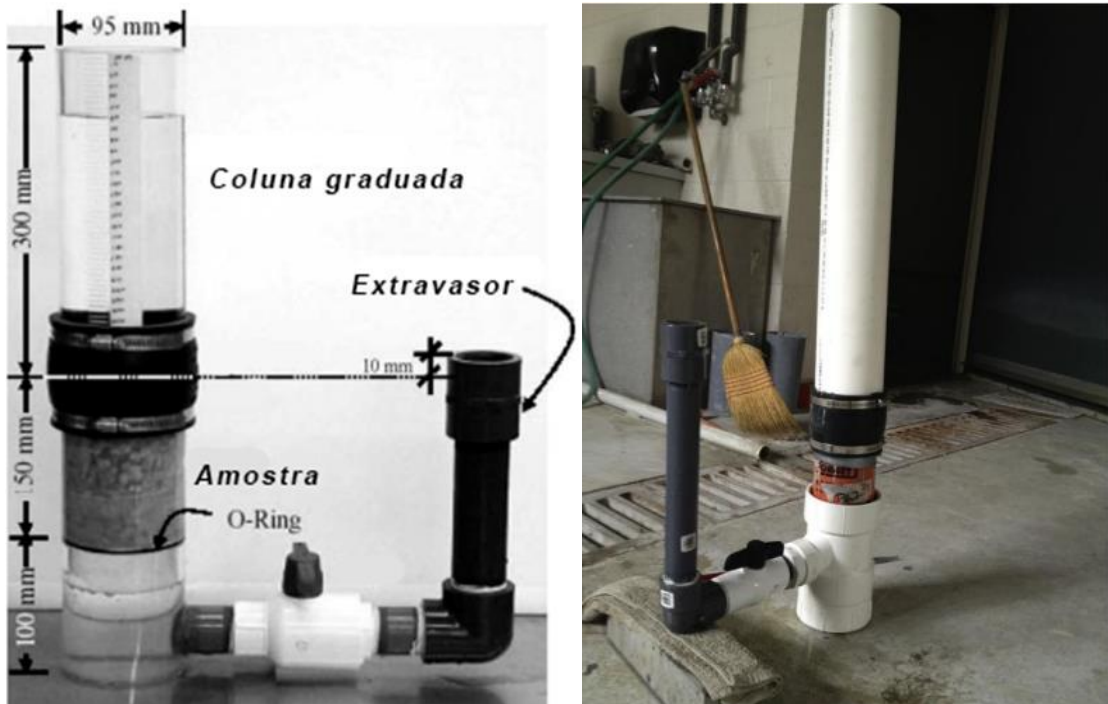
Figura 6 – Permeâmetro de carga variável (a) e permeâmetro de carga constante (b)
