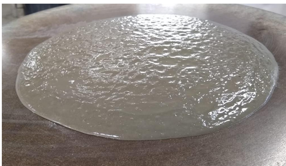
Figura 19 - Ensaio para definição do ICp após o abatimento
