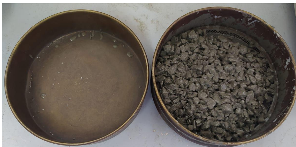
Figura 16 - Teste de drenagem de pasta para a/c de 0,32
