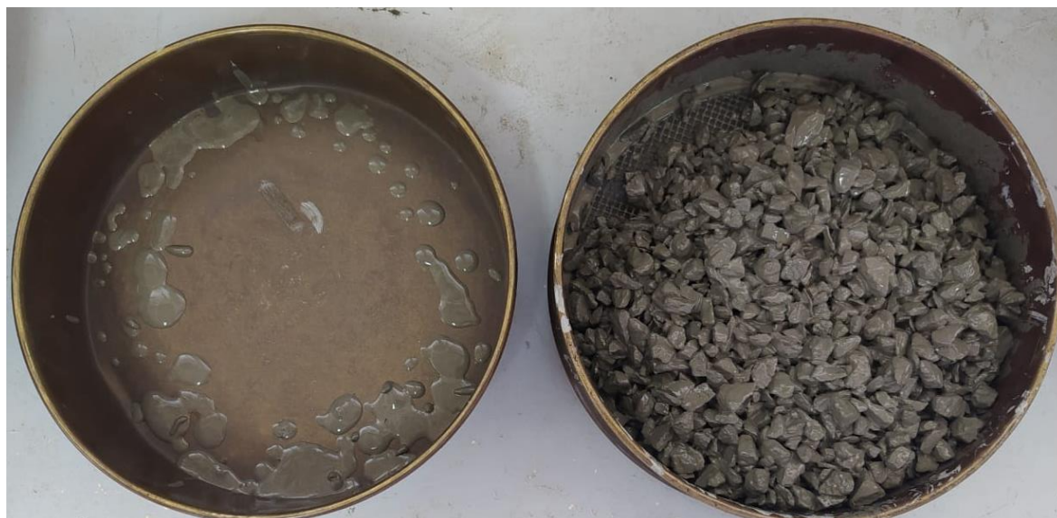
Figura 17 - Teste de drenagem de pasta para a/c de 0,34
