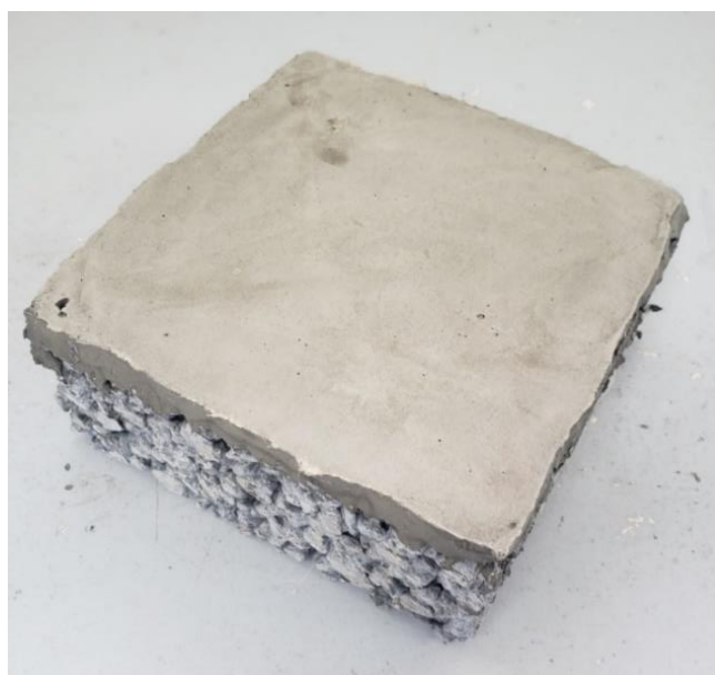
Figura 22 - Padrão de capeamento com pasta de cimento
