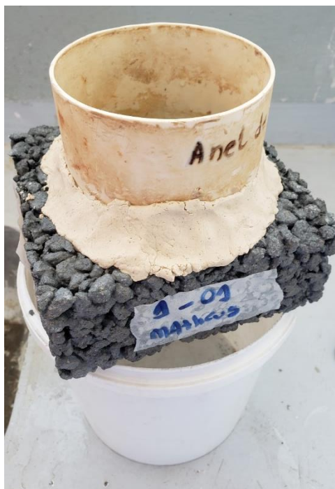
Figura 21 - Ensaio de infiltração das peças de concreto permeável
