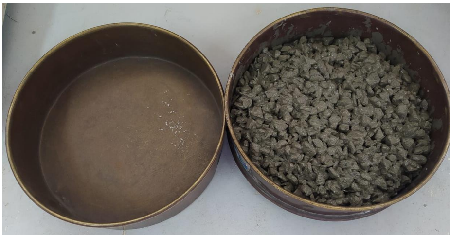
Figura 15 - Teste de drenagem de pasta para a/c de 0,30
