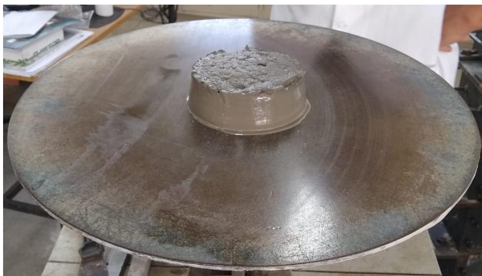
Figura 18 - Ensaio para definição do ICp antes do abatimento
