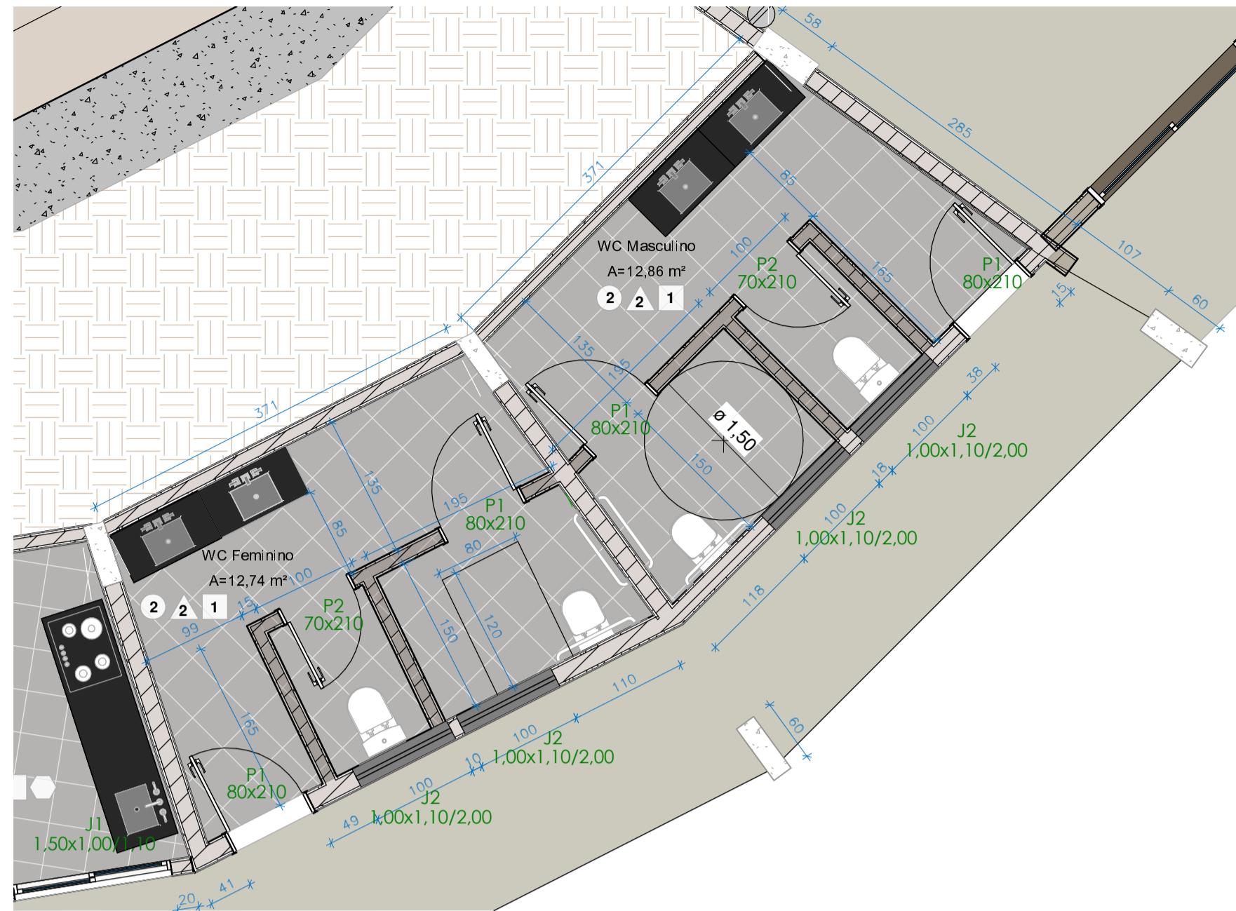
4 DETALHAMENTO BANHEIRO ESCALA 1 : 50
