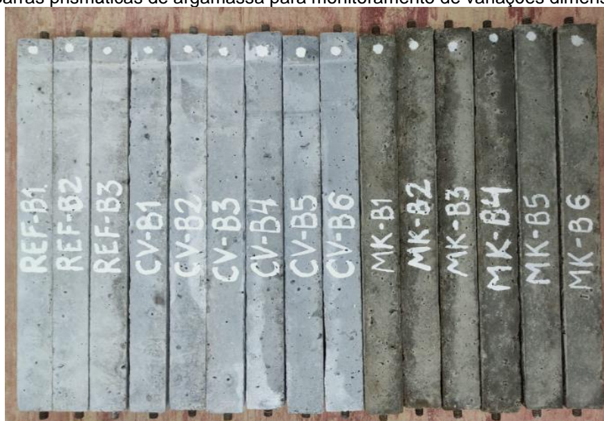
Figura 16 - Barras prismáticas de argamassa para monitoramento de variações dimensional lineares.
