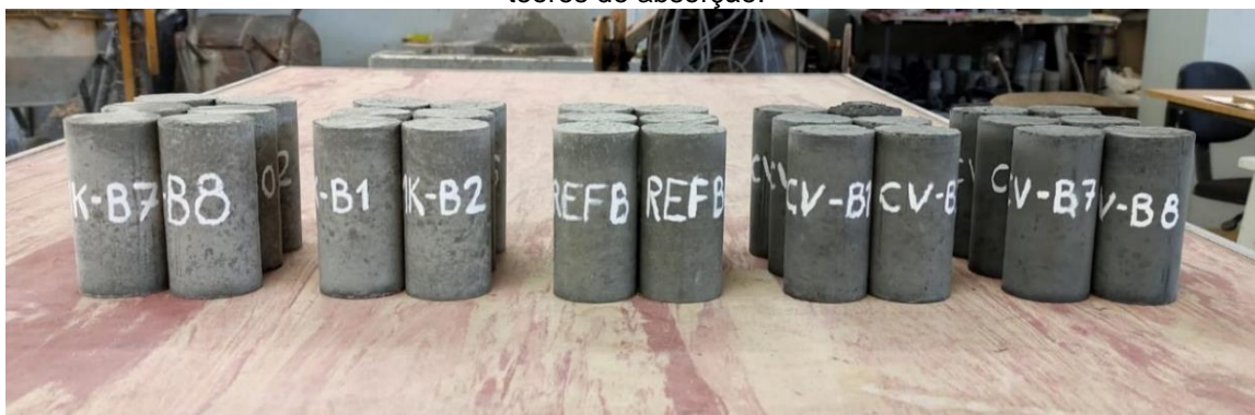
Figura 17 - Corpos de prova para rompimento por compressão axial aos 28 dias e determinação de teores de absorção.
