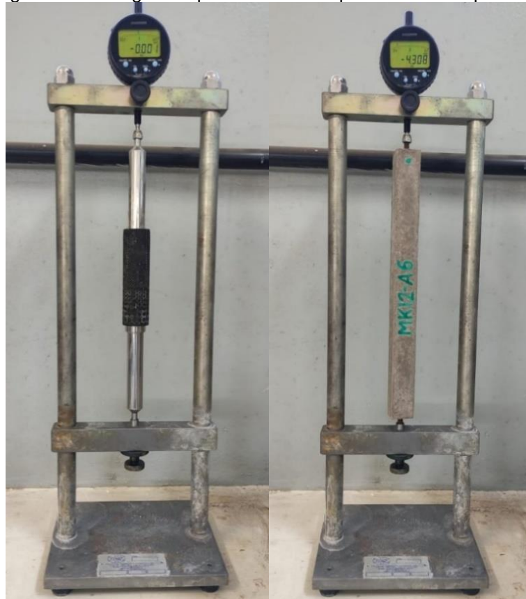
Figura 21 – Relógio comparador utilizado para aferir as expansões
