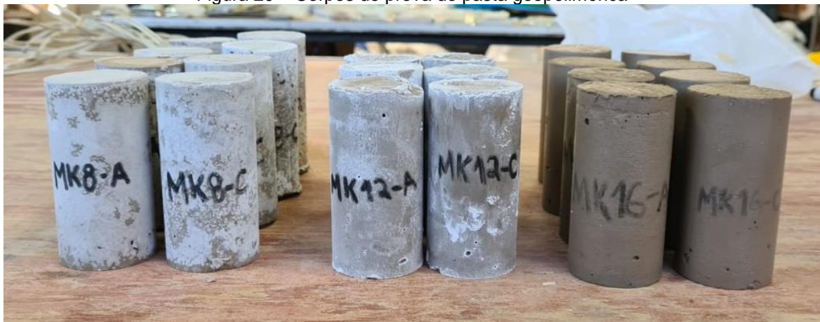
Figura 20 – Corpos de prova de pasta geopolimérica
