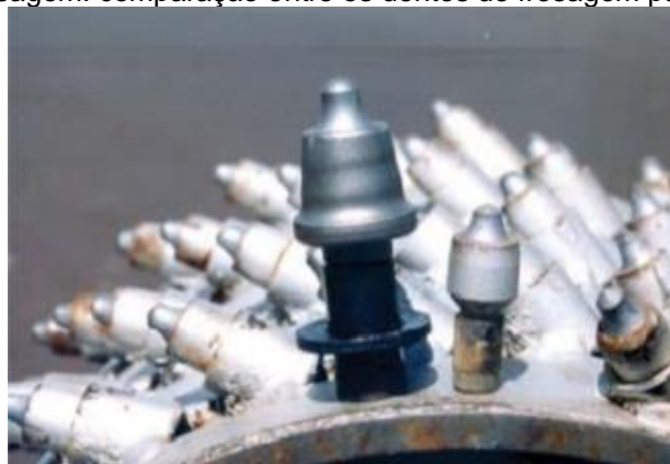
Figura 1 – Bits de fresagem: comparação entre os dentes de fresagem padrão e microfresagem
