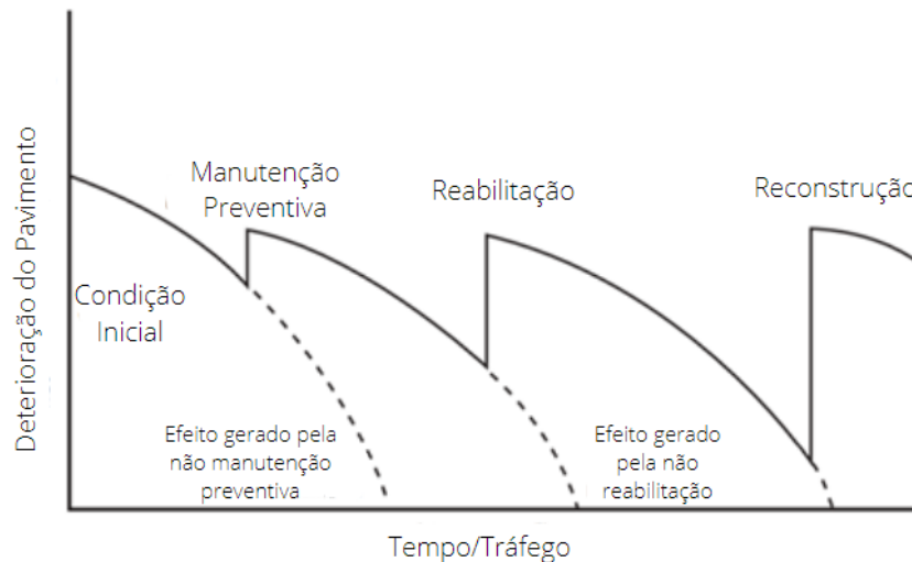
Figura 8 – Deterioração do pavimento x Tempo/Tráfego
