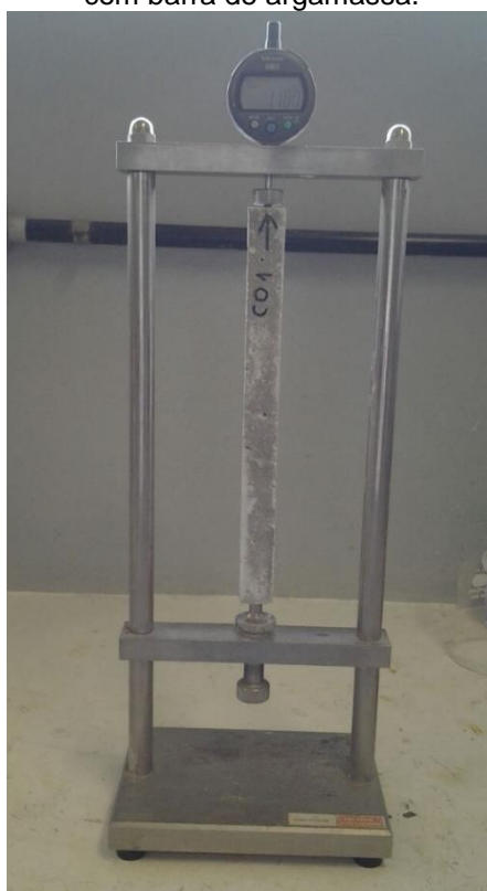
Figura 15 – Pórtico com relógio comparador para leituras de variação linear em barras de argamassa com barra de argamassa.
