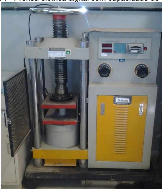
Figura 14 - Prensa elétrica digital com capacidade de 1000 kN.
