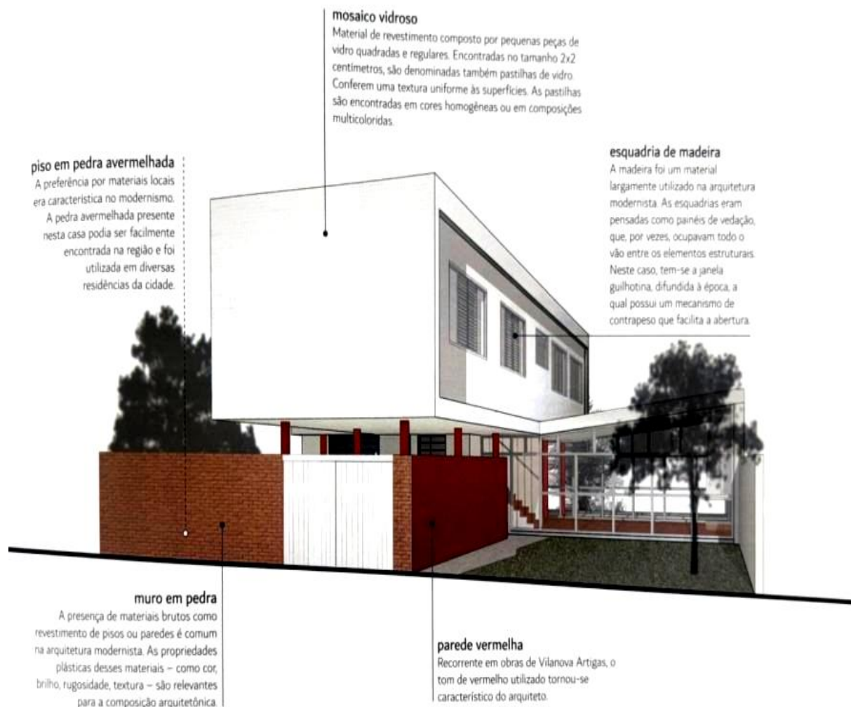
Figura 12 – Elementos característicos da fachada da Casa Correia de Sá
