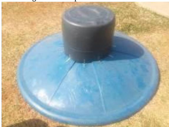
Figura 15: Tampa do reator finalizado.
