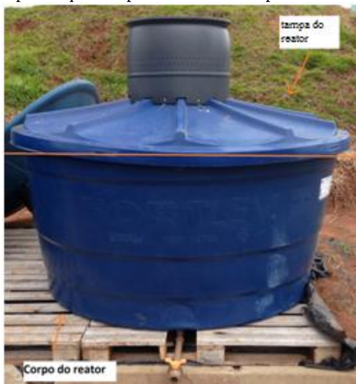
Figura 12: As duas principais partes que compõem o reator: tampa do reator e corpo do reator.
