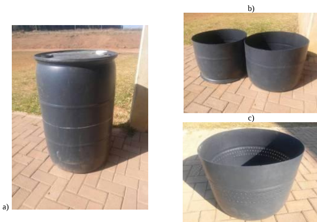
Figura 14: Fases de construção do trocador gasoso do reator a) Tambor utilizado na construção do reator com a marcação para o corte; b) As duas metades do tambor utilizadas na construção do reator; C) Orifícios de 5mm de diâmetro dispostas no centro da parede do trocador gasoso.
