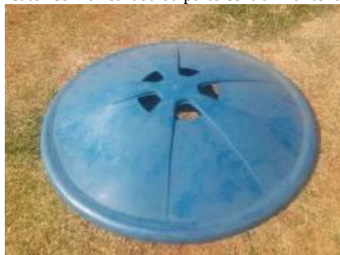
Figura 13: Tapa do reator com a retirada da parte central mantendo a estrutura da caixa.
