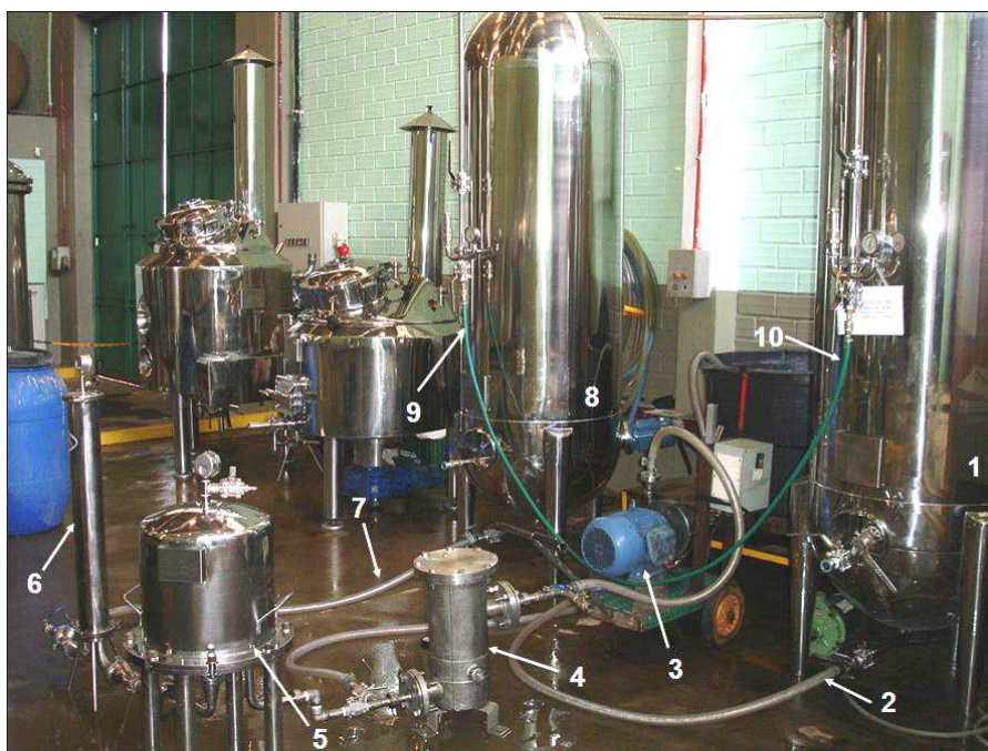
FIGURA 19 – Processo de filtração isobarométrica.
