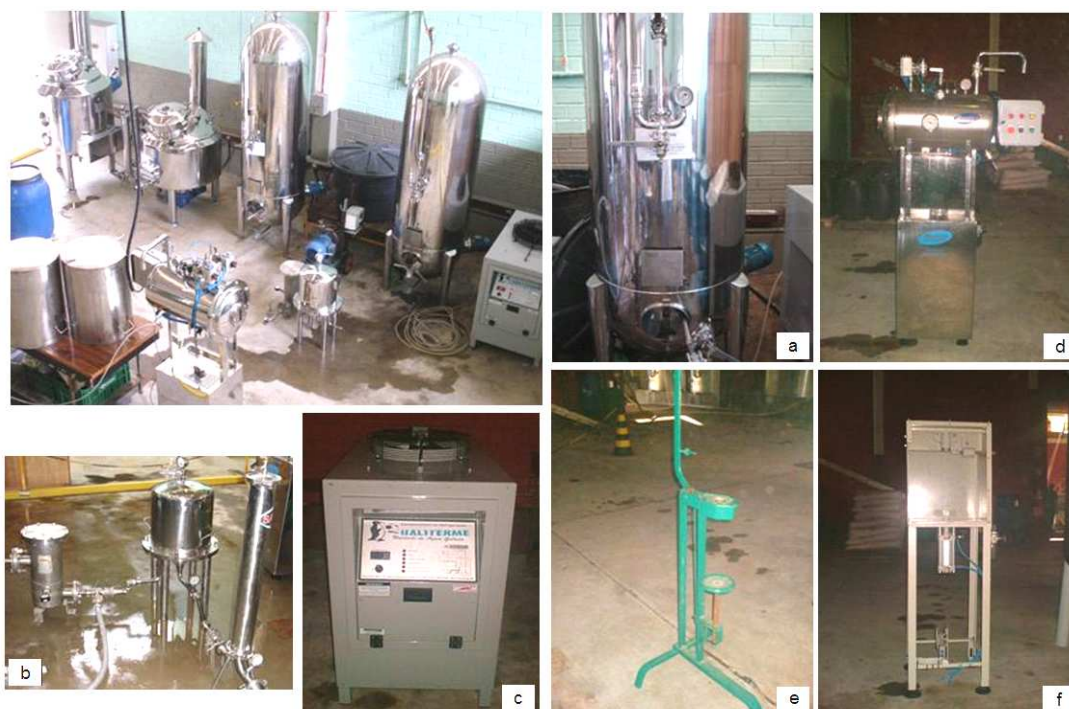
FIGURA 4 – Planta piloto cedida pela Agrícola Fraiburgo – Videira (SC), onde: a) dorna pressurizada, b) filtros isobarométricos, c) tanque térmico, d) enchedora isobarométrica, e) arrolhadora e f) engaioladora.
