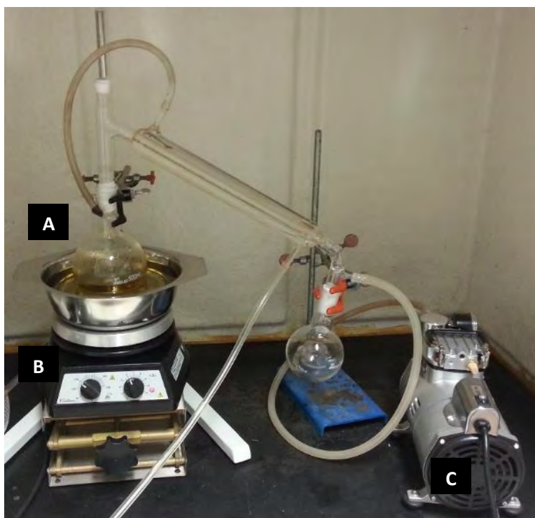
Figura 1- Montagem para o processo de poli condensação do ácido láctico: A-Balão com duas bocas 500 mL; B- Placa de aquecimento e C- Bomba a vácuo
