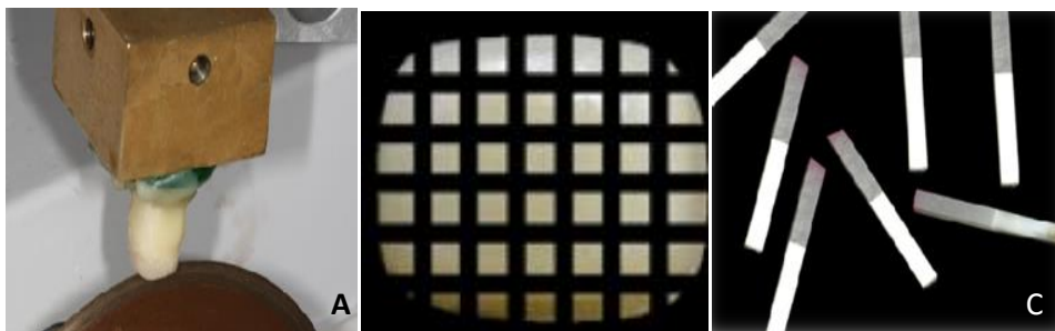
Figura 4 – Obtenção dos espécimes em resina-dentina. Em A , máquina de corte para obtenção de espécimes de resina-dentina em forma de palito utilizando disco de diamante. Em B e C e aspecto dos espécimes obtidos.
