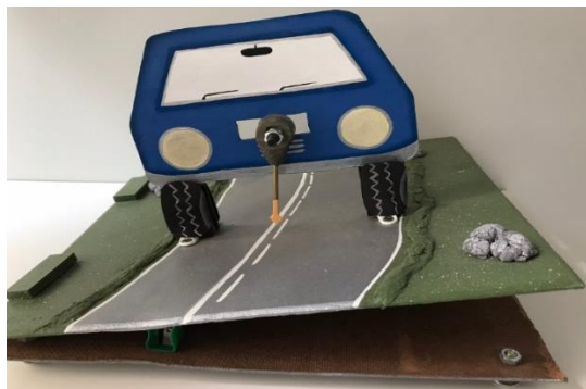
Figura 19: Veículo inclinado e ponteiro indicando a inclinação.
