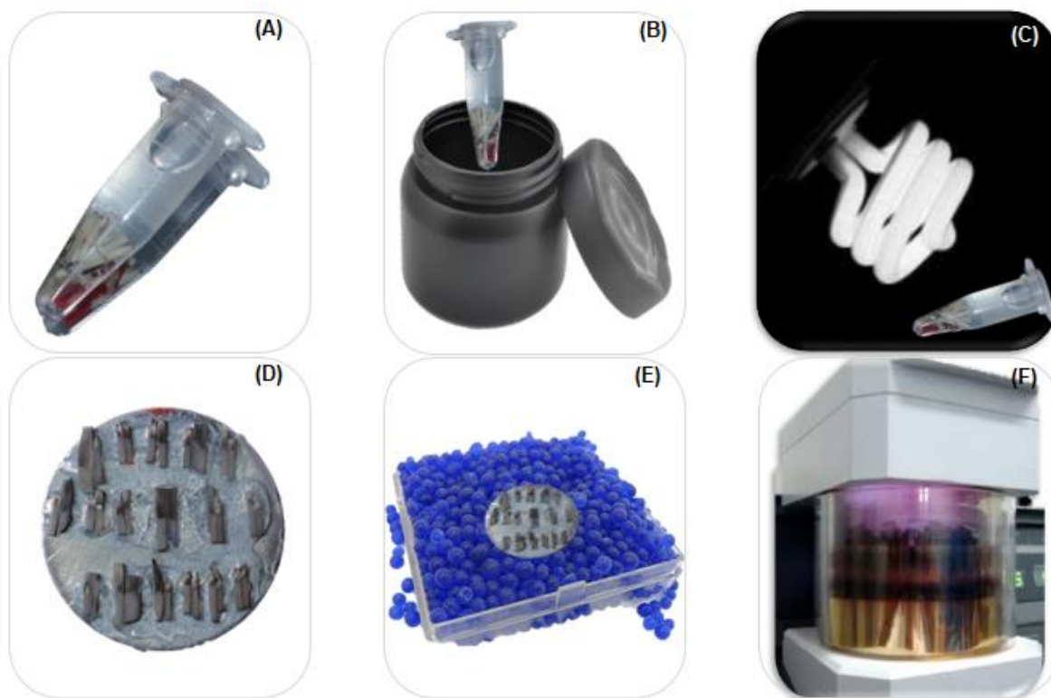
Figura 15. Preparação de amostras para NI: (A e B) imersão dos palitos em solução aquosa de nitrato de prata na ausência de luz (24h); (C) imersão em solução reveladora sob luz fluorescente (8h); (D) palitos revelados montados em stubs de alumínio; (E) palitos dessecados em sílica (24h); (F) metalização carbono-ouro.
