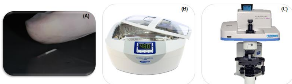
Figura 16. Grau de conversão (Raman): (A) polimento da amostra em lixa carbureto de silício #1500; (B) lavagem dos palitos em cuba ultrassônica; (C) equipamento Raman para leitura do espectro.
