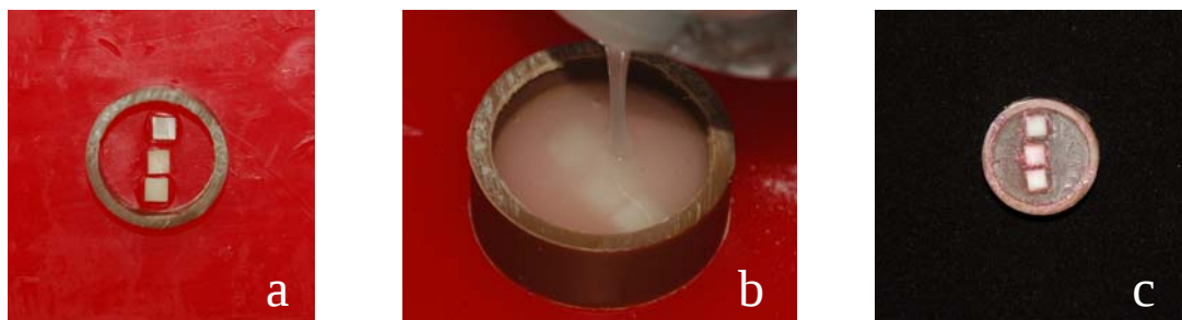
Figura 5 - a) Fragmentos posicionados em lâmina de cera para estabilização e envoltos pelo tubo de PVC. b) Inserção de resina acrílica autopolimerizável no interior do tubo. c) Corpo-de-prova
