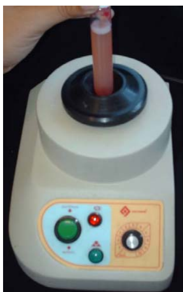
Figura 2 – Dentifrício teste (1,00 g) adicionado ao caldo Letheen submetido a um agitador durante 15 min. para completa diluição.
