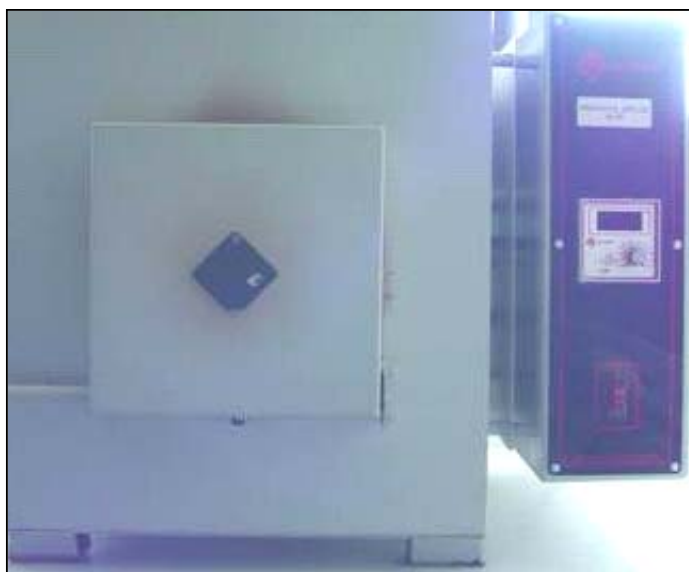
Figura 3 - Forno a 650°C para obtenção das cinzas a serem avaliadas em MEV e EDX.
