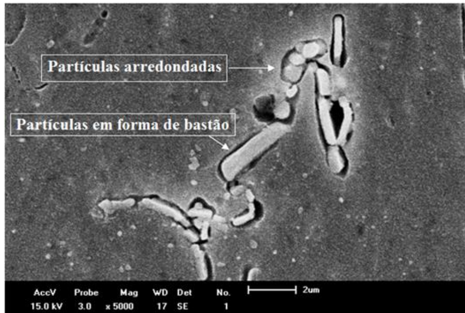
Figura 4.6 - Microestrutura da liga AA7050 envelhecida artificialmente na condição T7451, indicando as partículas intermetálicas incoerentes e sua respectiva morfologia. Imagem obtida por elétrons secundários. Reagente Keller.
