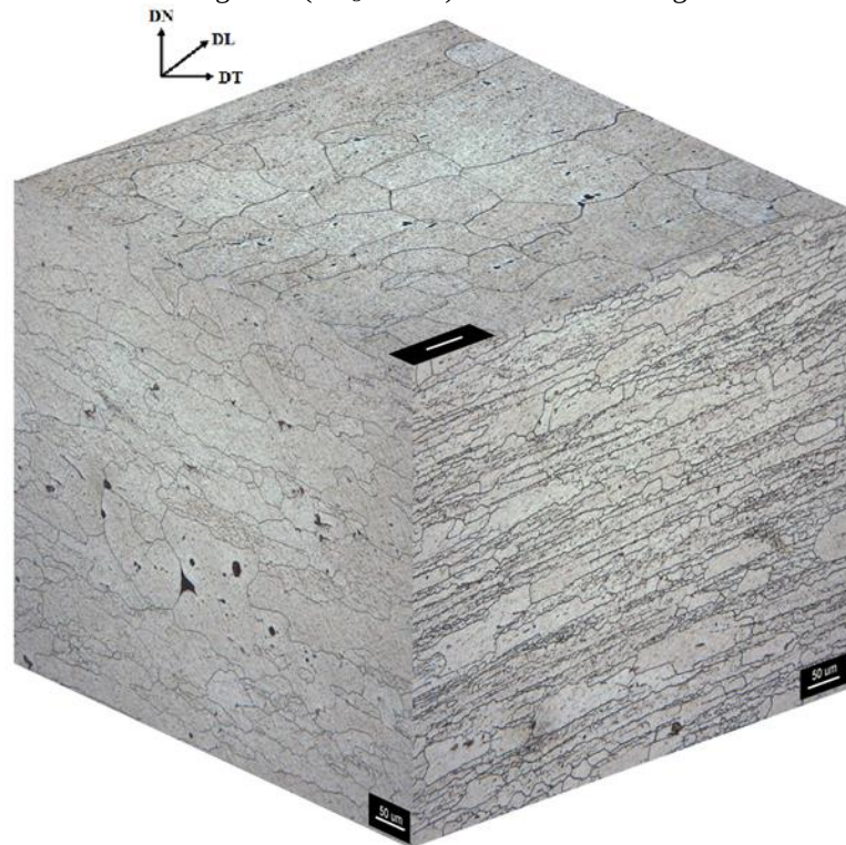
Figura 4.3 – Microestrutura da liga AA7050 solubilizada e envelhecida artificialmente na condição T6. Ataque: 1º etapa: solução de 40mL de ácido fluorídrico (HF) 40% e 40mL de água destilada, 2º etapa: 10mL de ácido nítrico ( \text{HNO}_3 ), 5mL de ácido acético glacial ( \text{CH}_3\text{COOH} ) 60% e 45mL de água destilada.
