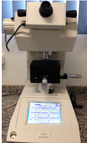
Fig. 14. Microdurômetro. O equipamento utilizado foi Shimadzu modelo (HMV-2. Japão). Fonte: autor
