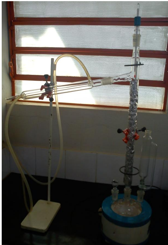
Figura 9 - Destilação fracionada com coluna de Vigreux. Fonte: o autor
