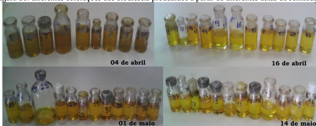
Figura 26: diferentes colorações dos biodieseis produzidos a partir de diferentes datas de semeadura
