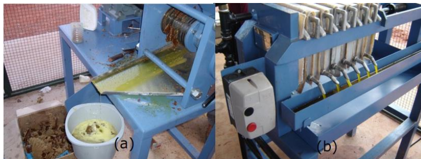
Figura 4: Extração de óleo de sementes ou frutos em prensa contínua (a) e filtragem do óleo obtido em filtro-prensa (b).
