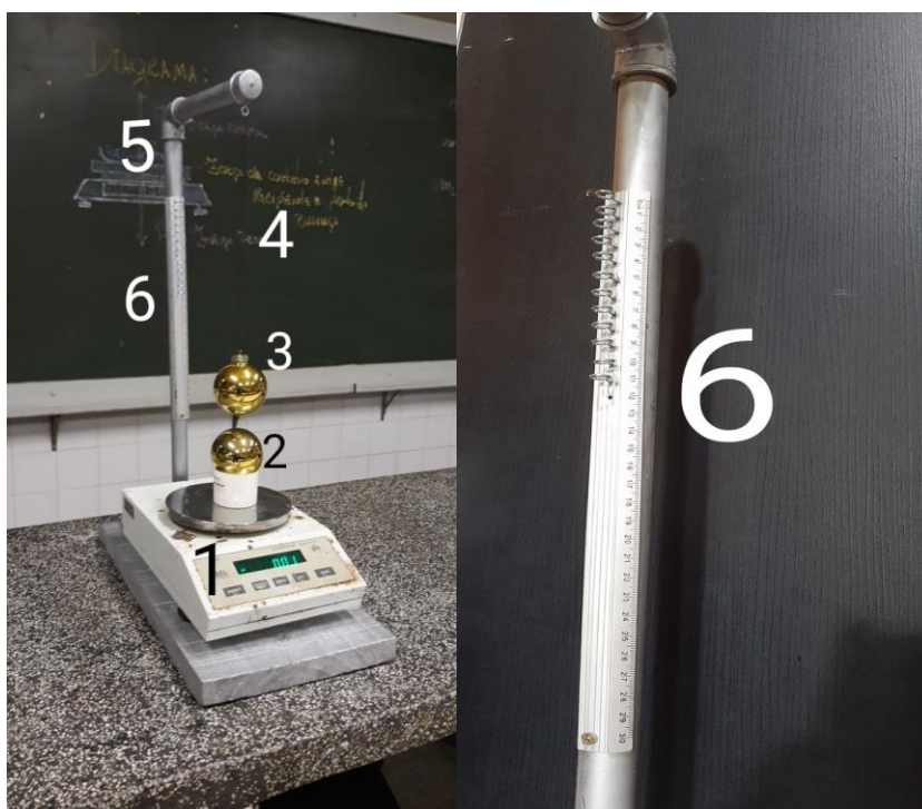
Figura 27: Aparato demonstração da lei de Coulomb
