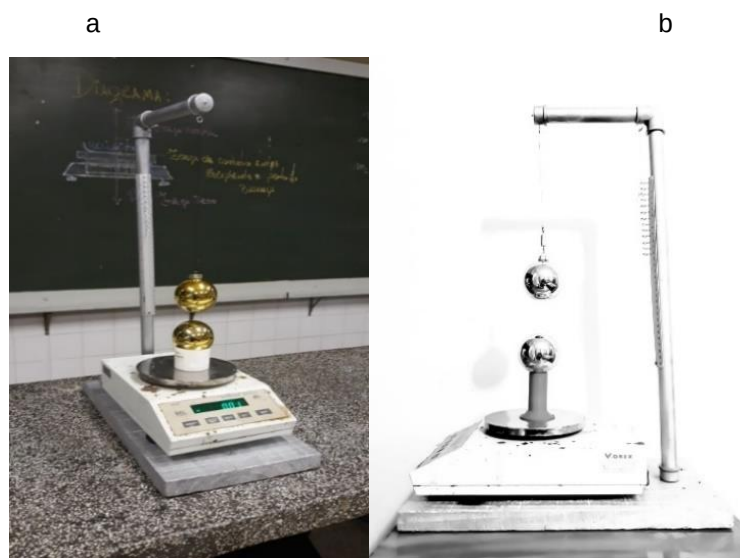
Figura 9 – Aparato para medir força de interação elétrica entre as esferas eletrizadas
