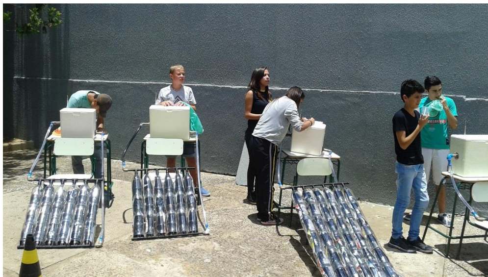
Foto 7 – Aquecedor solar com garrafas pet II
