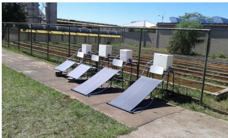
Foto 4 – Aquecedor solar com placa de pvc
