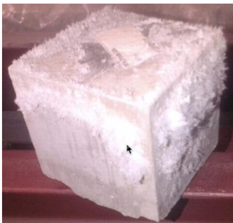
Figura 2.6: Exemplo de geopolímero a base de metacaulim com reações superficiais; disponível em [43].
