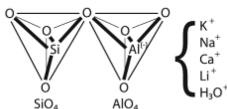
Figura 2.1: Concepção iônica da configuração tetraédrica do composto sialato ( \text{Si}-\text{O}-\text{Al}-\text{O} ) [27].
