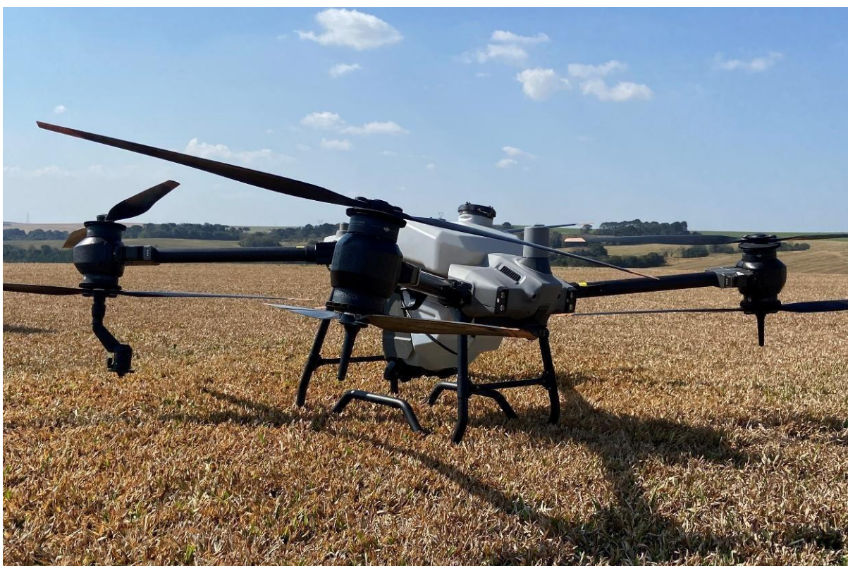
Figura 1 – Veículo aéreo não tripulado (VANT) DJI AGRAS T40™, com capacidade de tanque de 40 litros, oito rotores e equipado com dois bicos de pulverização rotativos LX8060 SZ™, utilizado no experimento sobre faixa de pulverização com diferentes diâmetros de gotas, realizado em julho de 2025, em Palmeira – PR.
