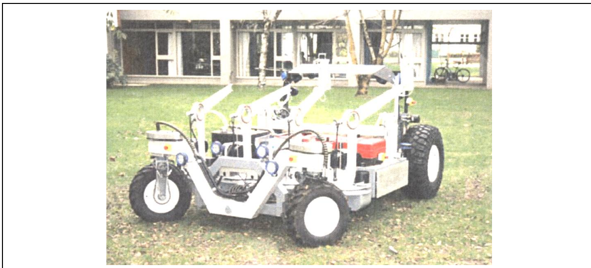
Figura 25 – Robô móvel com quatro braços robóticos baseado em visão computacional para colher kiwis (Massey et al., 2009).
