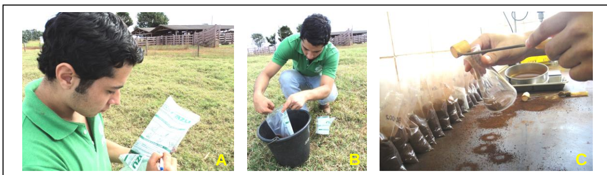
Figura 31 – A) identificação de cada amostra, B) homogeneização e acondicionamento no saco plástico, C) amostra sendo manipulada no laboratório (FAZU, 2011).
