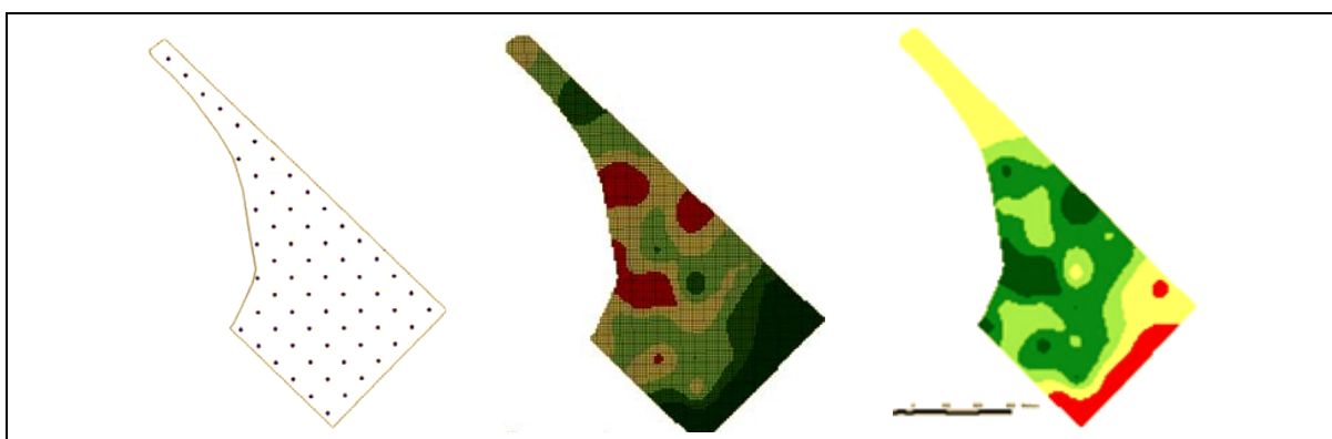
Figura 32 – Exemplo do plano de amostragem georreferenciada (de pontos) de solo para geração do mapa de fertilidades e recomendações, variando ao longo do talhão (MAPA, 2013).
