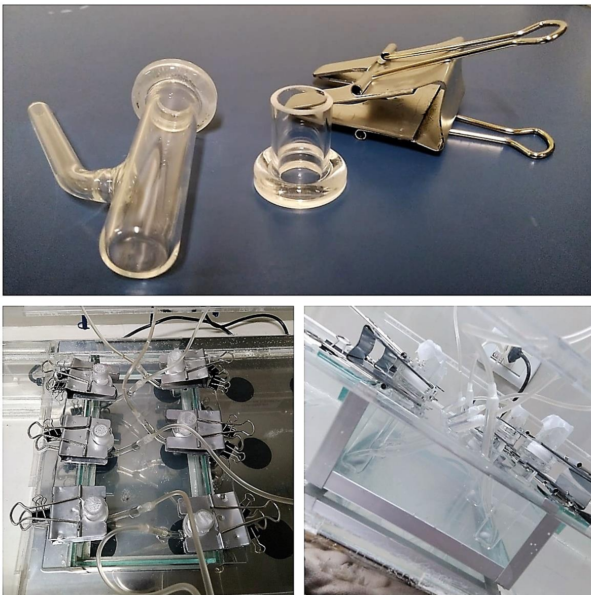
FIGURA 11 – Células verticais estáticas de difusão de Franz utilizadas para os experimentos
