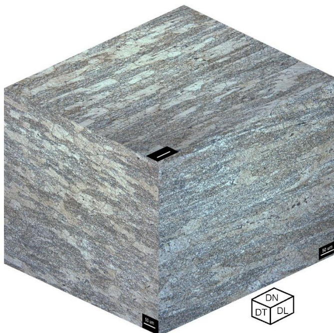
Figura 4.5. Microestruturas de uma amostra da liga AA7050 das três direções seguindo o proposto na Figura 3.3 para amostra na condição T7451. Reagente: como descrito em material e métodos.
