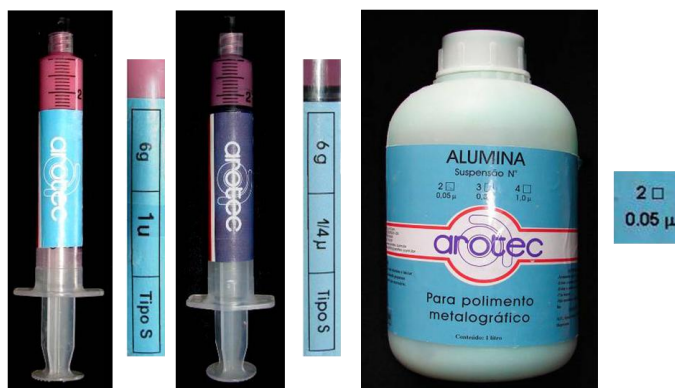
Figura 11 – Seqüência de pastas diamantadas utilizadas no polimento das amostras, granulação decrescente 1 µm (rosa), 1/4 µm (roxa) e 0,05 µm (verde).
