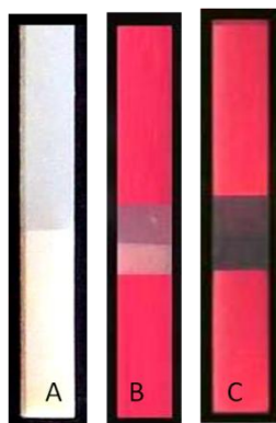
Figura 8 – A) cp confeccionado; B) cp isolado com esmalte (apenas a interface dente/restauração exposta) e C) cp infiltrado com nitrato de prata.
