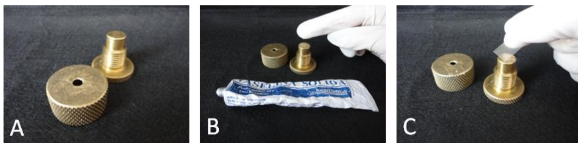
Figura 22 - A) matriz utilizada para confecção dos corpos de prova; B) aplicação de vaselina; C) colocação de uma tira de poliéster na base da matriz metálica.
