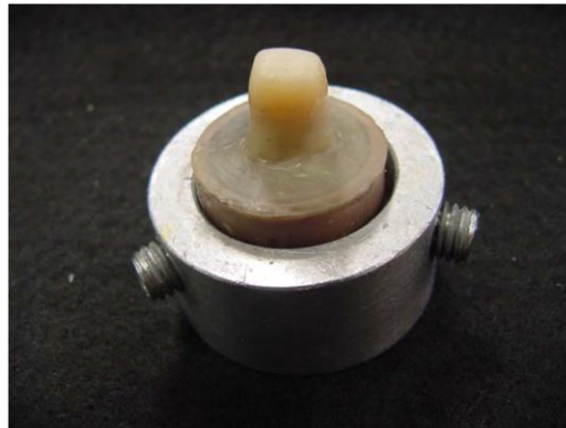
Figura 4 – Corpo de prova (CP) fixado no anel que se acopla à máquina de corte.
