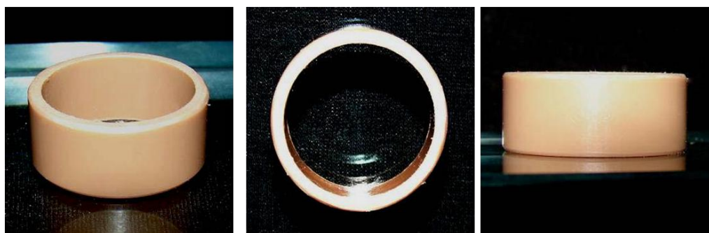
Figura 9 – Matriz de PVC confeccionada para o embutimento dos cp (dimensões: 2 cm de diâmetro e 1 cm de altura).
