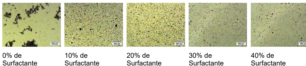
Figura 36 - Microscopia ótica da dispersão do Grafite com diferentes concentrações de surfactante.
