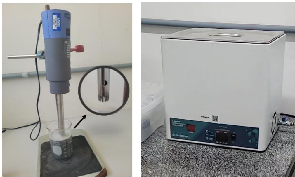
Figura 22 – A - Dispensor mecânico Ultra Turrax T18 – Ika e B - Ultrassom de banho 40Khz
