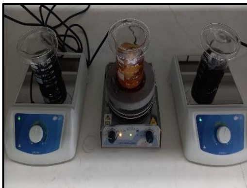
Figura 17. Aplicação dos dispositivos DGT nas frações bioacessíveis deixados sob agitação magnética.
