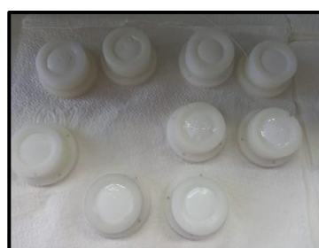
Figura 16: Montagem dos dispositivos DGT adicionando sobre a base os discos de chelex-100, hidrogel de agarose e membrana de nitrato de celulose, respectivamente (A) e ele pronto com a tampa para ser imerso nas amostras(B).
