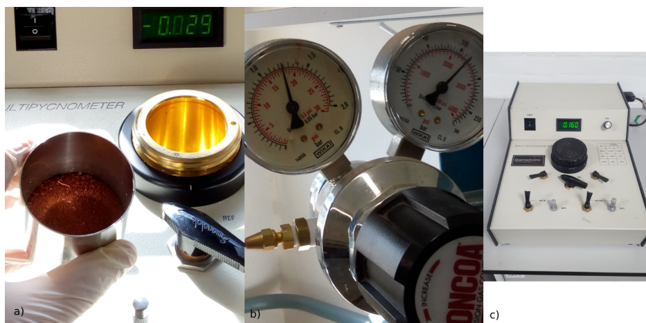
Figura 4.2 – Detalhes do aparelho de determinação de densidade de partícula a gás He: a) porta amostra preenchido com 80 g de amostra; b) medida de pressurização do sistema com 17 Psi; c) Multipicnômetro Quantachrome Instruments MVP-D169-E .
