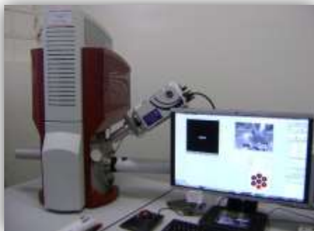
Figura 10: Microscópio Eletrônico de Varredura com Fonte de Emissão de Campo (MEV-FEG).
