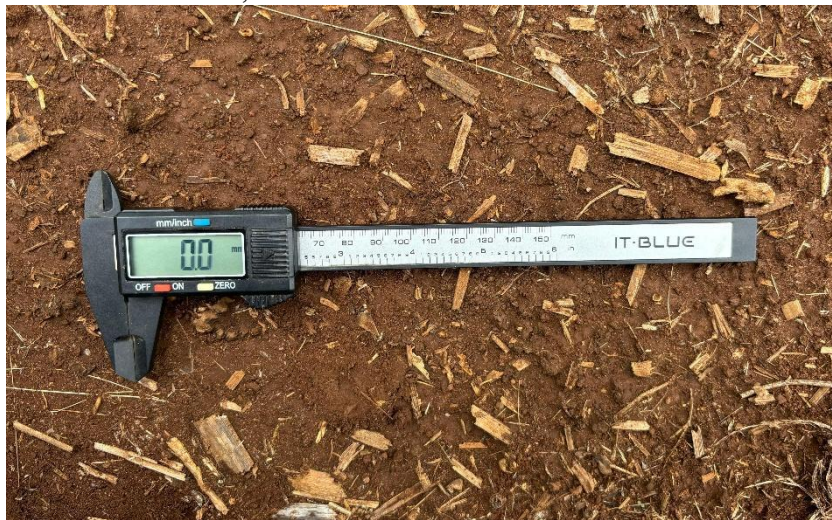
Figura 3 - Equipamento paquímetro digital It. Blue utilizado na aferição do parâmetro de diâmetro de colmo no experimento. Ponta Grossa, 2024.
