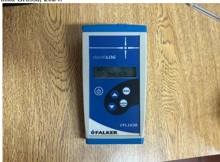
Figura 2 - Equipamento clorofilômetro ClorofiLOG CDL1030 para a aferição dos teores de clorofila A e B no experimento. Ponta Grossa, 2024.
