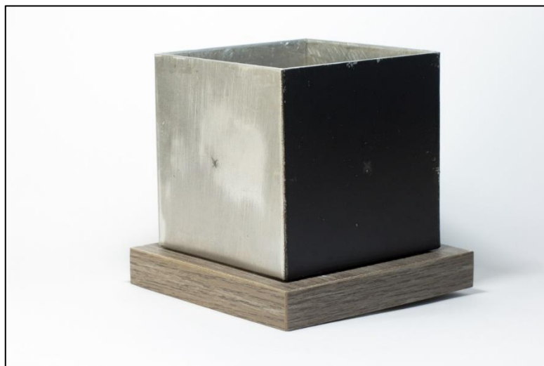
Figura 52. Cubo de Leslie tradicional com detalhe para as faces fosca e preta.
