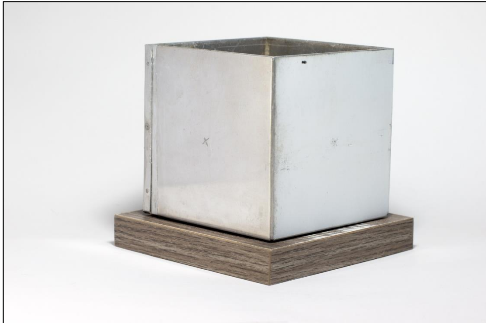
Figura 15. Cubo de Leslie com detalhe para as faces polida e branca.
