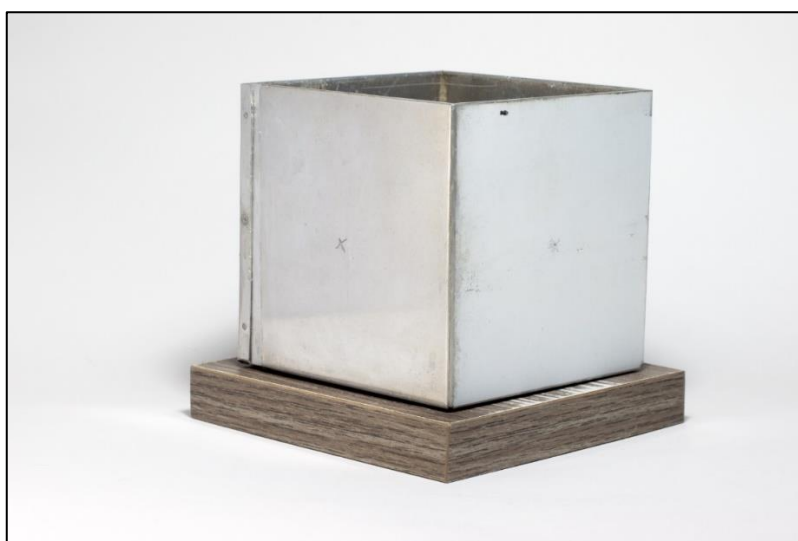
Figura 53. Cubo de Leslie tradicional com detalhe para as faces polida e branca.
