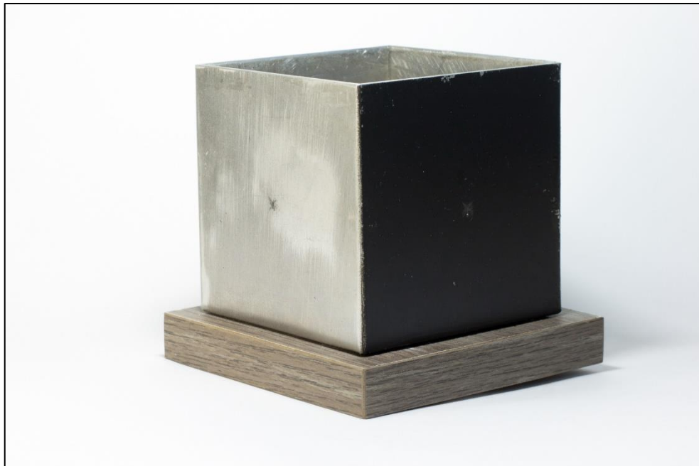
Figura 14. Cubo de Leslie com detalhe para as faces fosca e preta.
