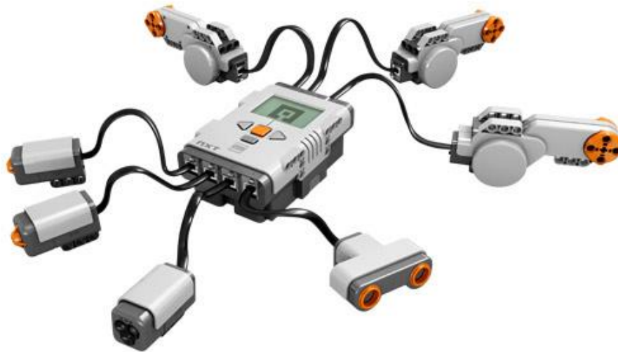
Figura 5. Ao centro o micro controlador NXT. Acima os servos motores. Abaixo da esquerda para direita os dois sensores de toque, o sensor de cores/luz e o sensor ultrassônico.
