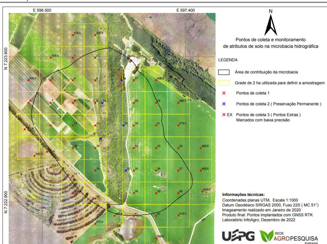
Figura 11 - Mapa da microbacia Lajeado da Onça com a grade regular fixa e identificação do centroide (Ponto de coleta).
