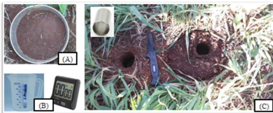
Figura 6: Sequência da determinação da K_{fs} . Anel cravado ao solo (A). Saturação e cronometragem do tempo de infiltração (B). Local de realização da K_{fs} e coleta de anéis (C). Fonte: A autora (2018).
