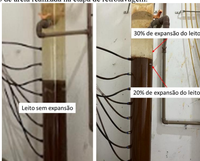
Figura 13 - Expansão do leito de areia realizada na etapa de retrolavagem.
