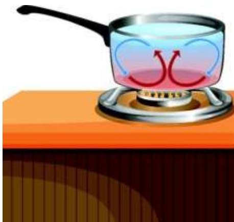
Figura 11: Transferência de calor por convecção
