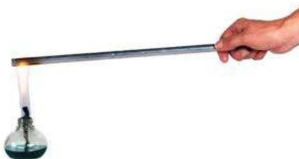
Figura 10: Transferência de calor por condução
