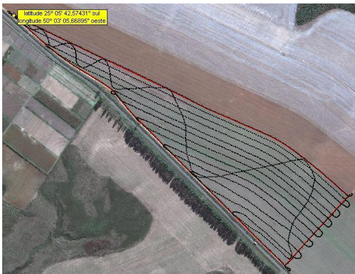
Figura 18 - Pontos coletados na fazenda escola da UEPG, durante levantamento absoluto cinemático realizado com veículo, velocidade entre 9 e 16 km/h Fonte: Imagem capturada com software TrackMaker, banco de imagens públicas Google Earth
