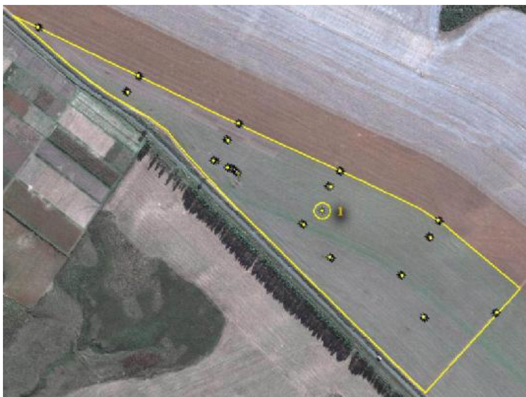
Figura 17 - Pontos coletados na fazenda escola da UEPG, durante levantamento absoluto cinemático realizado a pé com velocidade entre 3 e 5 km/h
