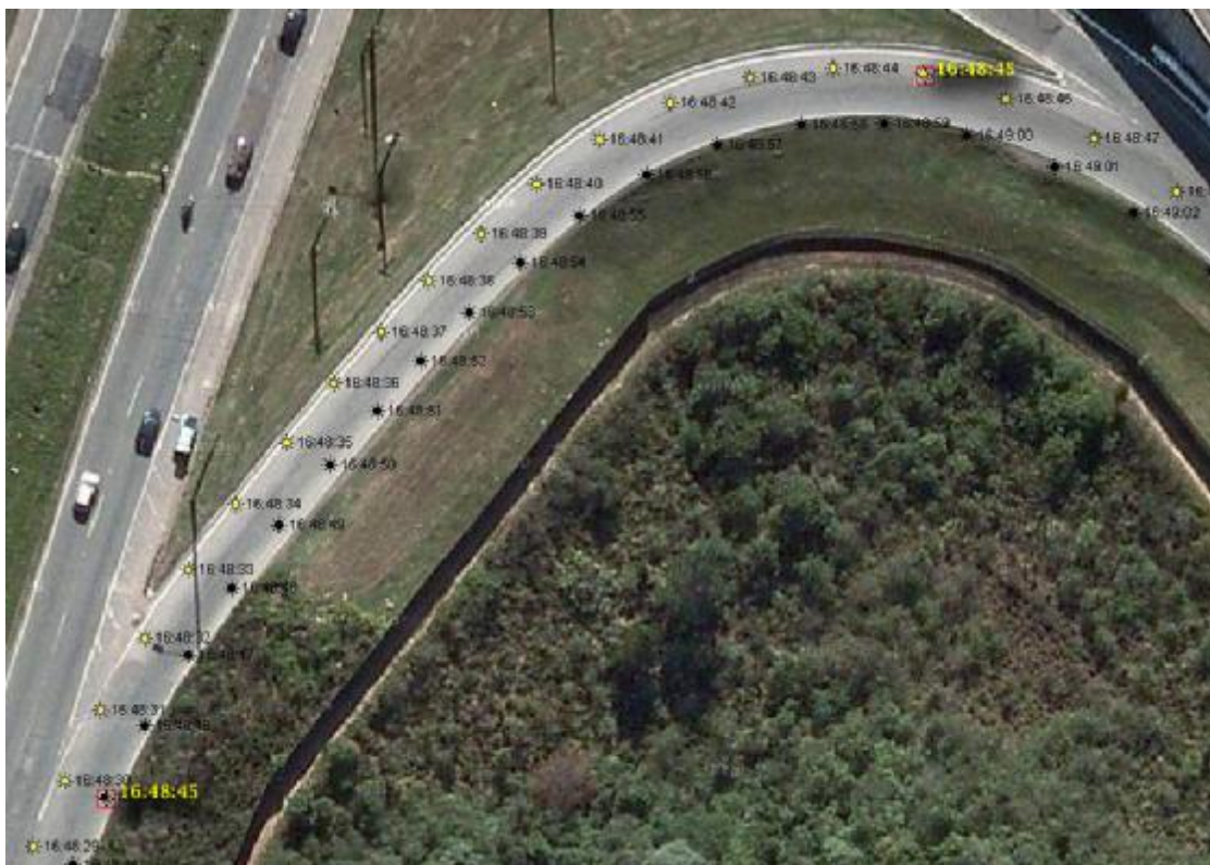
Figura 20 - Pontos coletados no contorno sul da BR-116, durante levantamento absoluto cinemático realizado nas ruas do entorno ao Centro Politécnico da UFPR, indicação de diferença de 15 seg na coleta dos dados pelo receptor GPS Gstar GS-87
